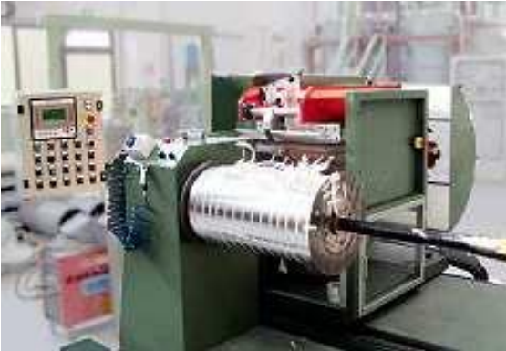
Realizzazione di avvolgimento M.T. per trasformatore in resina, con macchina completamente automatica
