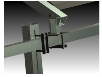
dettaglio collegamento fondazione (A) / struttura
